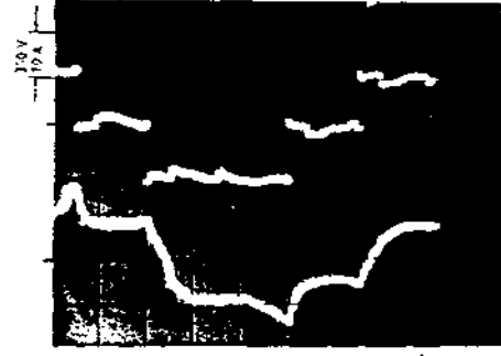
Şekil 4.1 . Motor faz gerilimi ile faz akısı.
