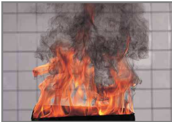
Test yangını TF5: sıvı yangını (n-heptane):
