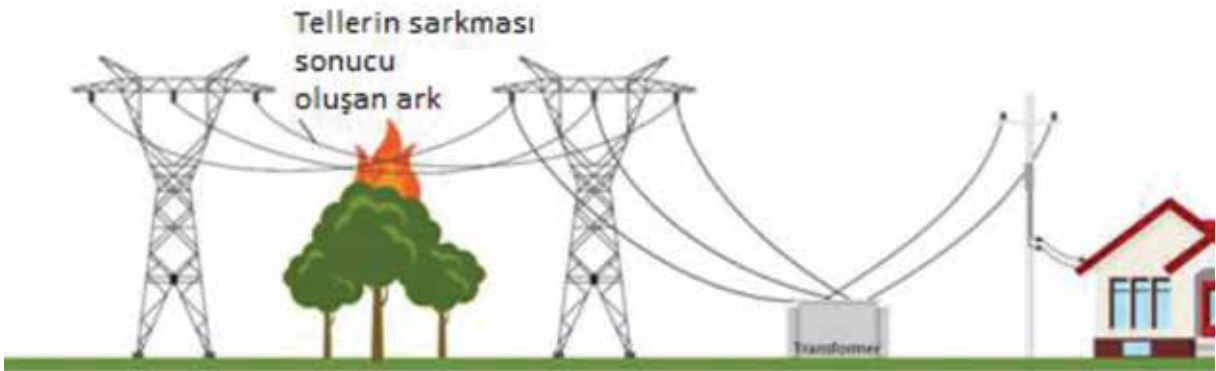
Şekil 2. İletim Hatlarının Sarkması Sonucu Oluşan Yangın
