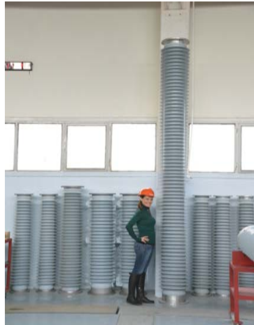
Şekil 32: 170kV v 525 kV Akım transformatörü için Polimer İzolatörler
