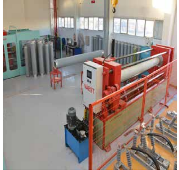
Şekil.13-Kompozit Boru ve Flanjin ısı ile bağlanması
