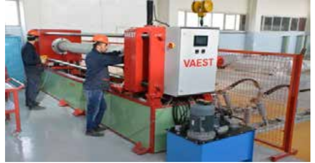
Şekil 31: Oyuk İzolatör Flanj Bağlama ve Çok Amaçlı Test Cihazı
