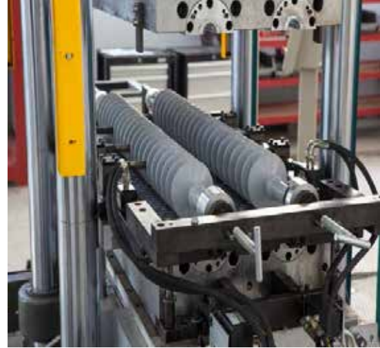
Şekil.16: 500Ton macun silikon (HCR) kalıp ve makinesi
