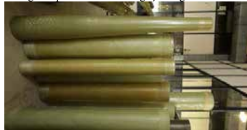
Şekil 9: Filaman sargılı Borular
