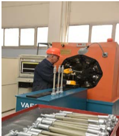
Şekil 11. FRP Çubuk için Metal uç sıkma
