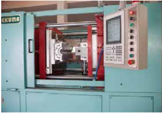
Şekil 15 : Yatay çalışan sıvı silikon için örnek bir pres
