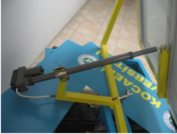
İşkil 7. Yükselme-Açılma motorunun sistem üzerindeki görüntüsü
