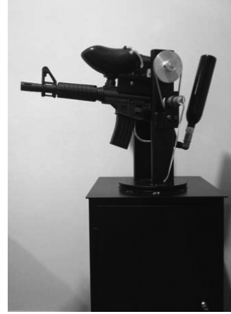
Şekil 6: Gerçekleştirilen uzaktan kumandalı güvenlik sistemi.
