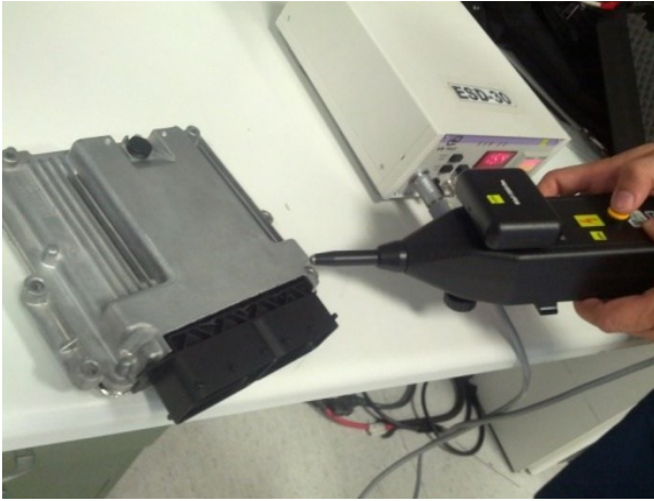
Şekil 7. ESD Test Düzeneği
