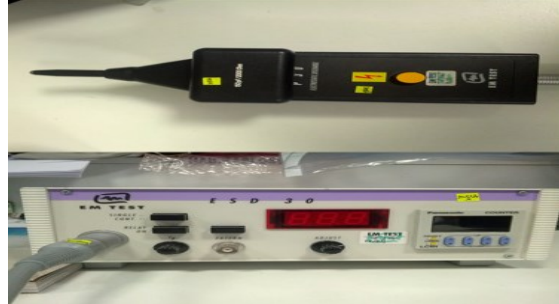
Şekil 6. ESD Test Cihazı Ve Probu
