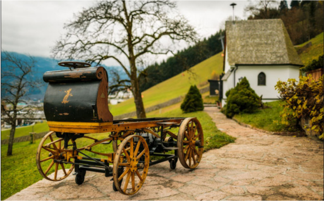
Porcshe P1 Avusturya 1898, Ferdinand Porsche tarafından elektrik bataryasıyla sekiz kenarlı bir elektrik motoru çalıştırılarak yapıldı. Motor gücü 2,2 Kw (3 hp)
