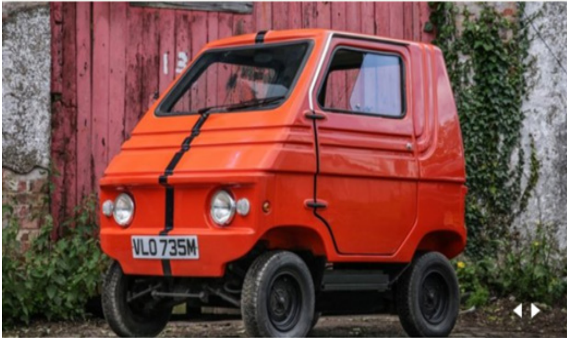
Zagato, Zagato Zele (Zagato Elcar) 1974 elektrikli araç, İtalya-Milano. 40 - 50 km/h max hız. Motor gücü: Mirelli doğrudan tahrik. Akü: 2 x 12 V - 8 x 12 V. Menzil: 80 km
