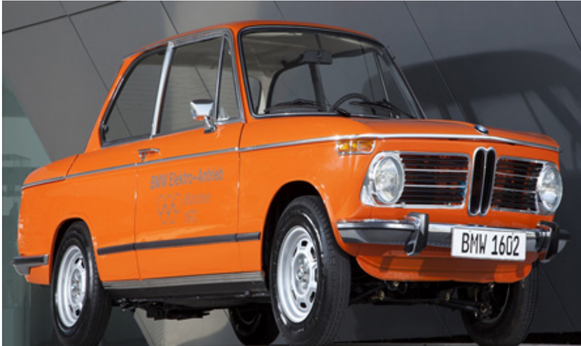
BMW 1602E 1972 model elektrikli araç, Almanya. Motor gücü: 43 hp. Akü: 12,6 kWh. Menzil: 30 km
