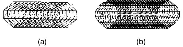
Şekil:4 a) M=3,NP=96,NE=180 ve b) M=5, NP=260, NE=500 değerleri için elde edilmiş elemanlar.
