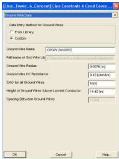
Fig. 9. 24xG652 OPGW conductor data
