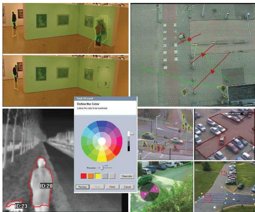
Şekil 8. Akıllı İçerik Analizinde Renk Tanıma Özelliği, Kayıp Nesne Alarmı, Çizgi Geçme ve Yön Algılaması, Perspektif Ölçeklendirmesi, Gece Kızılötesi Aydınlatmalı Ortamda Algılama Örnekleri.
