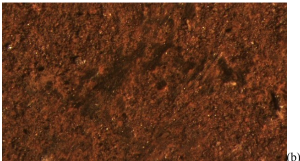
Şekil 4: (a) Korozyonsuz ve (b) korozyonlu mıknatısların yüzey görüntüleri
