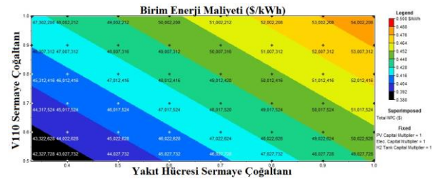
Şekil 9: Yakıt hücresi fiyatlarındaki azalmaya bağlı olarak birim enerji ve toplam maliyetlerin değişimi
