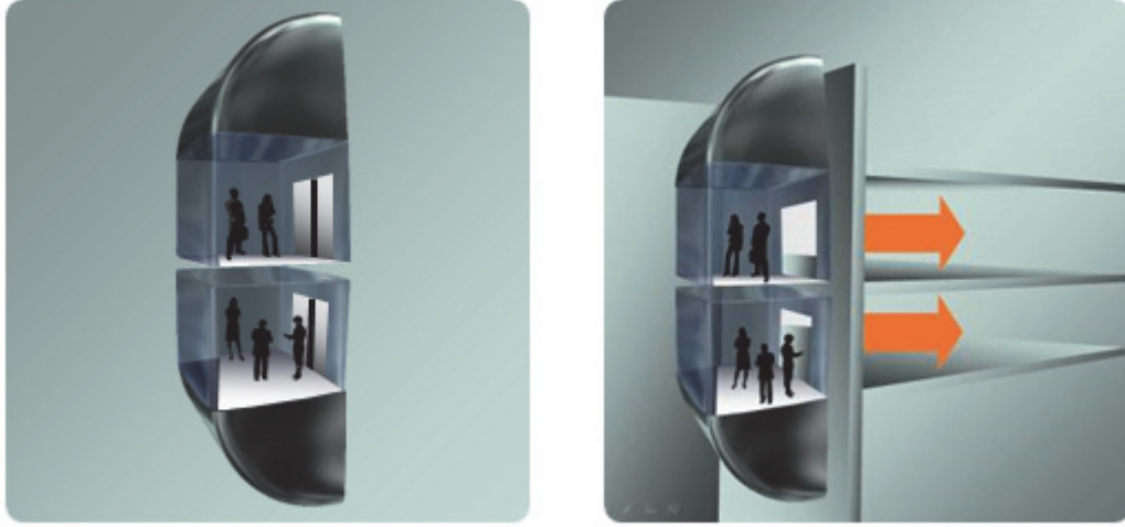
Şekil 1. Çift katlı asansör sisteminde üst üste konumlandırılmış iki kabin
