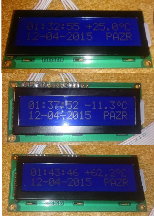
Resim 6: Temel ısı ölçüm sonuçları a) 25°C b) -11.3°C c) +62.2 °C
