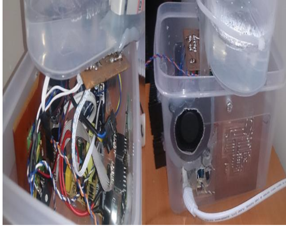
Resim 7: Ultrasonik Nebulizator iç ve arka görünüş
