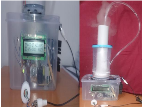
Resim 8: Ultrasonik Nebulizator prototip görünüşü ve çalışması
