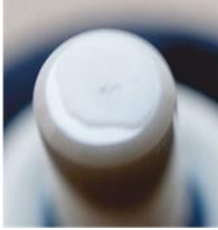
Şekil 1: Fiber optik uçucu organik bileşen sensörü
