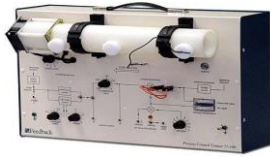
Şekil 1: Isıl sistem modeli
