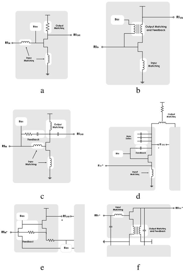
Figure 1 : Single-Transistor LNAs :
