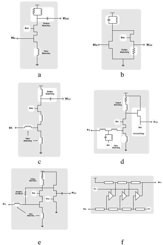
Figure 2 : Cascode-based LNAs
