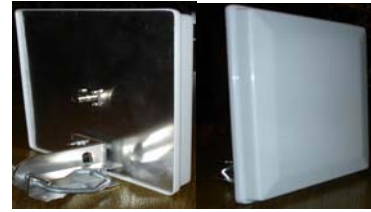
Şekil 7. Dış alan uygulamaları için mikroşerit yama anteni
