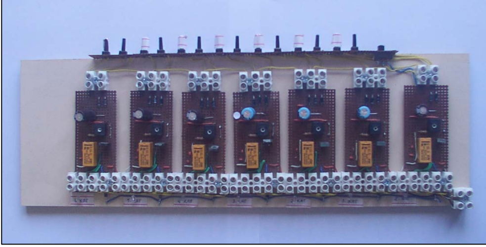
Şekil.1 Gerçekleştirilen PIC tabanlı akıllı merdiven otomatiği düzeneği.
