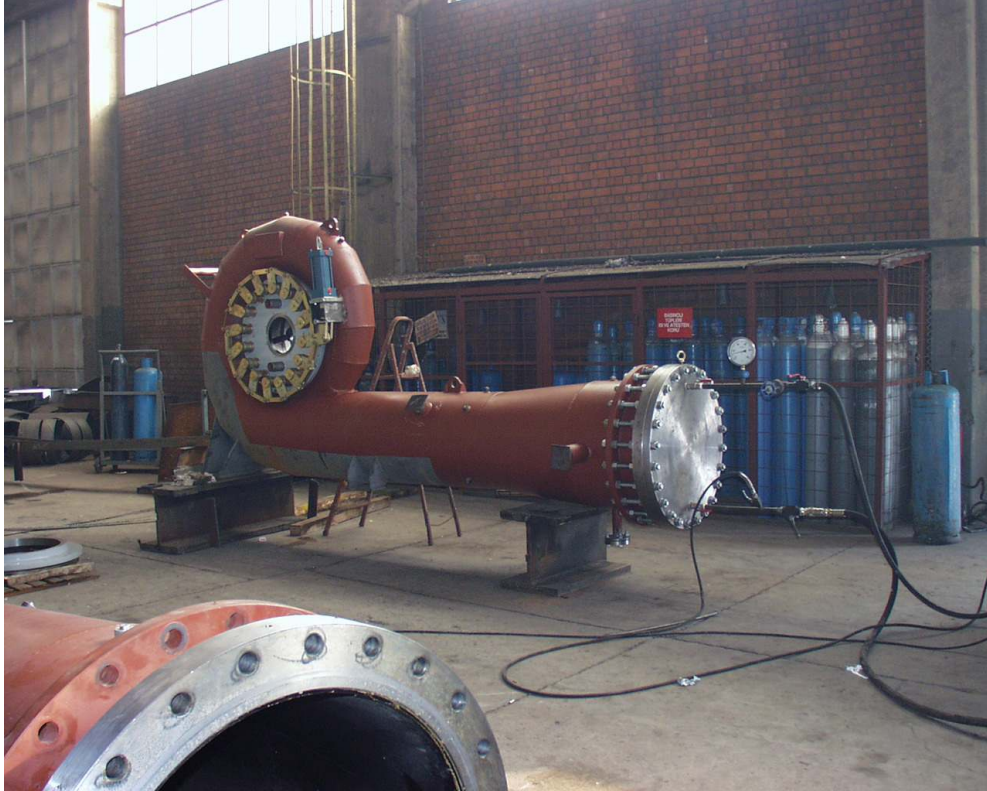
Resim 2: Yerli imalat ve ön montaj örneği, 1,1 MW Yatay Francis (Kaynak: Yazar'ın arşivi, Çal HES)
