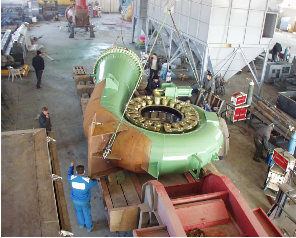
Resim 5: Yerli Ön Montaj örneği, 9 MW gücünde Yatay Francis (Kaynak: Yazar'ın arşivi, Pamuk HES)
