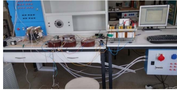
Şekil 3: Deney transformatörüne paralel bağlı diğer transformatör durumundaki deney düzeni
