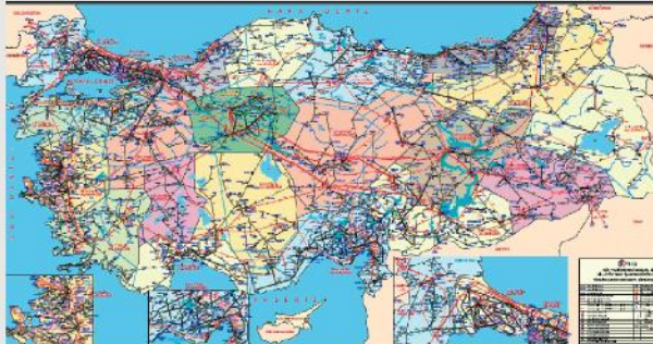
Şekil-1 Türkiye Enterkonnekte İletim Sistem Şeması, TEİAŞ Yük Tevzi Dairesi Başkanlığı (Nisan 2011)
